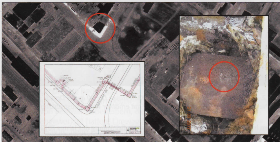
Bild 4. Leckage an einer Rücklauftrasse DN 500 eines kanalverlegten Dreileitersystems im Dresdener Osten
