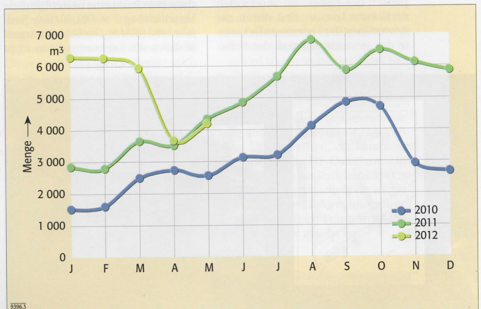
Bild 3. Aufwendungen für die Netznachspeisung in den Jahren 2010 bis 2012 bei der Drewag Netz
