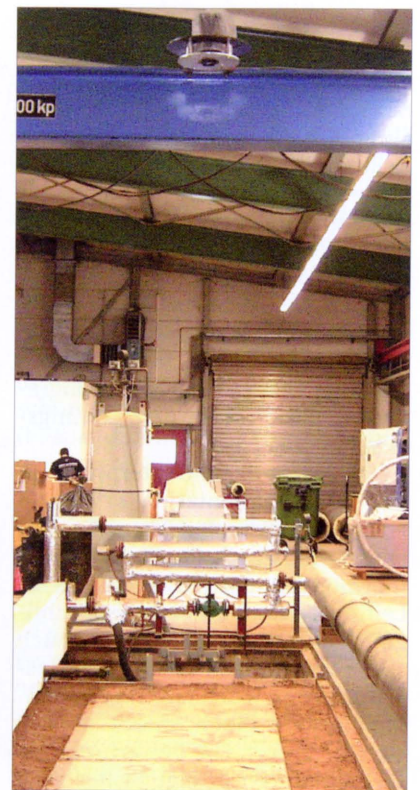
Bild 6. Wärmebildkamera auf dem Kran
